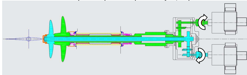
Rys. 2 Schemat konstrukcyjny klasycznego układu przeciwbieżnego [13]
